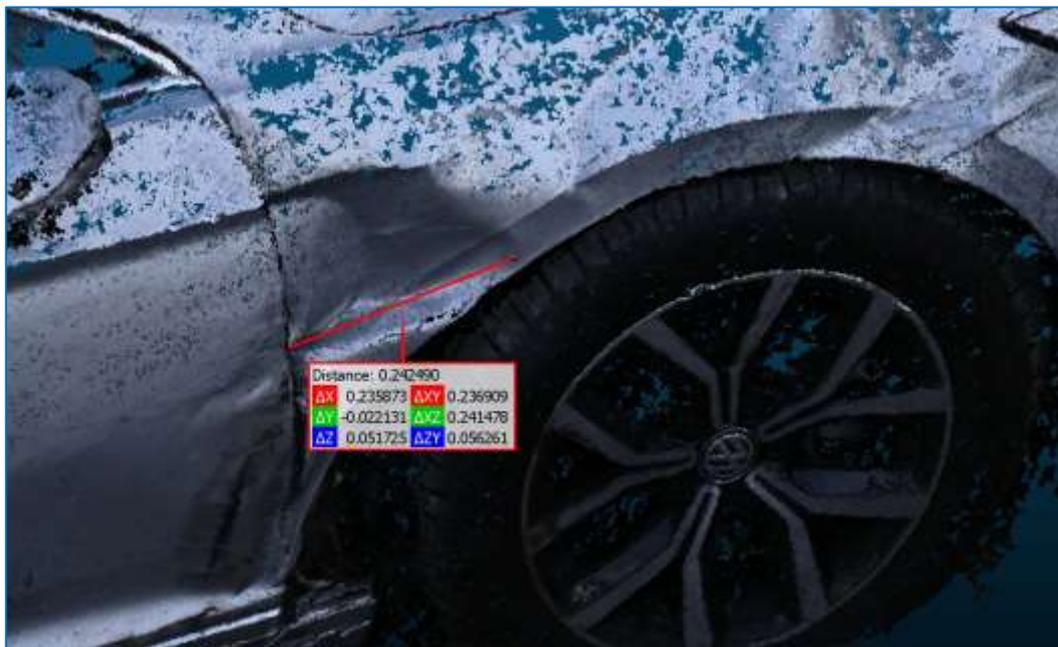
Figura 18 Sezione del veicolo. La freccia rossa indica la deformazione al parafrangente anteriore destro. Immagine tratta da PC-Crash 10.2.
